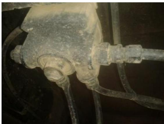
**figura 9** válvula de distribución para los actuadores
