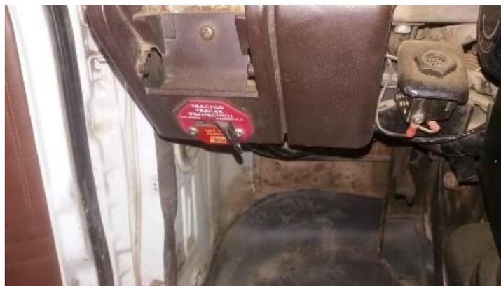
**figura 13** válvula de accionamiento manual
