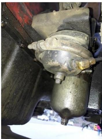
**figura 12** Actuador para el freno de maquina
