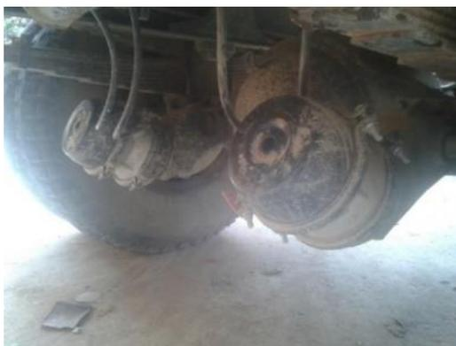
**figura 6** Demostración de los actuadores de doble efecto
