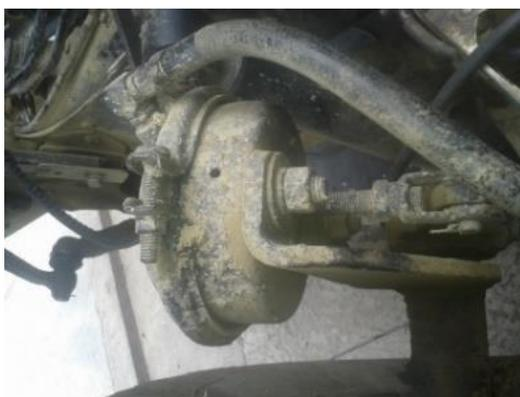
**figura 8** Actuador simple de doble efecto para los neumáticos delanteros
