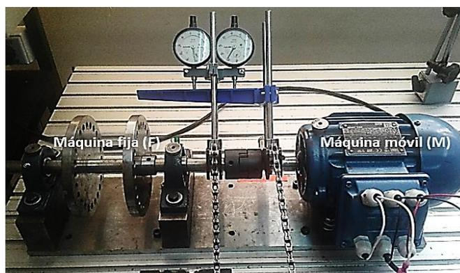
Para facilitar el proceso de alineación se colocó otros relojes comparadores (R3 y R4 de la Fig. 7) en sentido horizontal en la base de la máquina móvil a la altura de los pernos del lado libre y lado acople. Estos relojes indican con precisión el desplazamiento horizontal de la máquina móvil.
