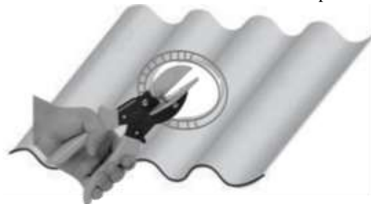
Figura 2: Cortes transversales de la circunferencia para adentarla
