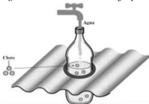
Figura 6: Llenado de la botella con agua y cloro
