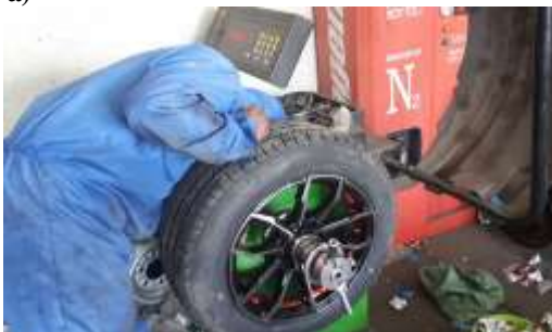
Figura 3: a) Balanceo de los neumáticos. b) Indicadores de corrección. c) Alineación de los neumáticos. d) Valores de corrección.
