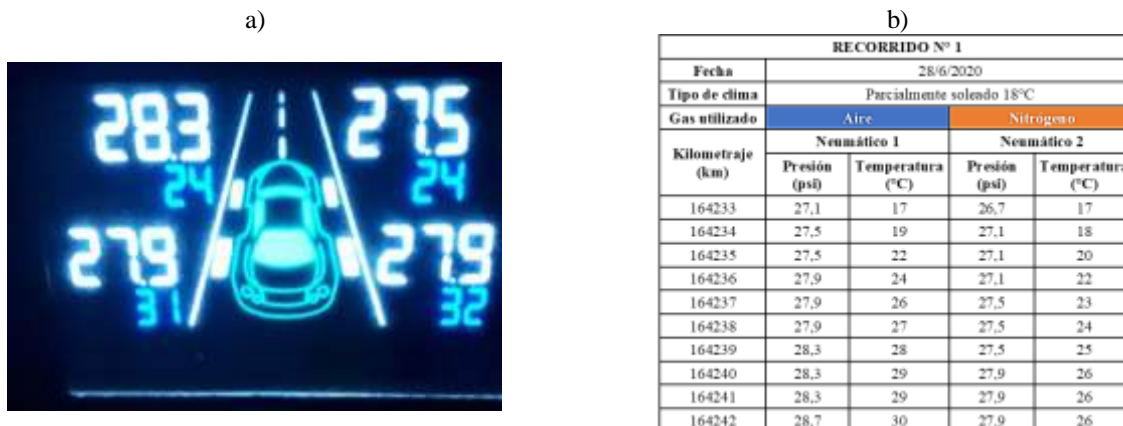
Figura 4: a) Datos de presión y temperatura de los neumáticos. b) Hoja de registro de datos.
