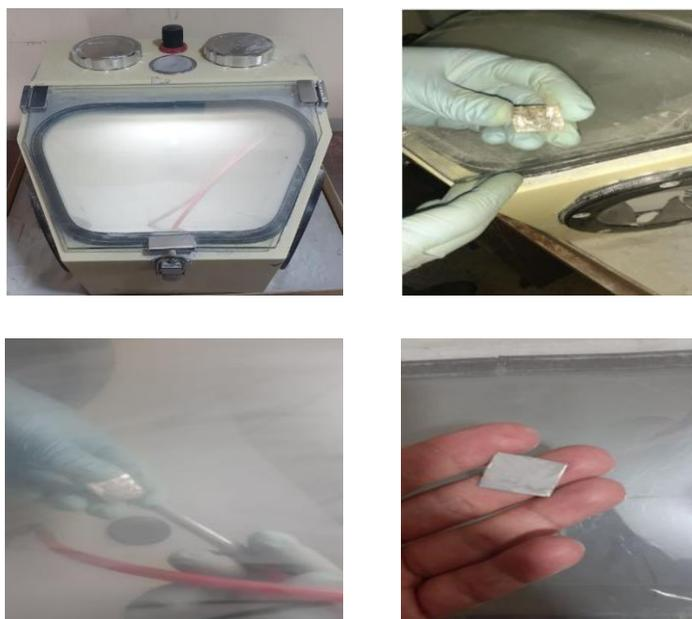
**Figura 4.** Arenador - Proceso de Arenado antes, durante y después
