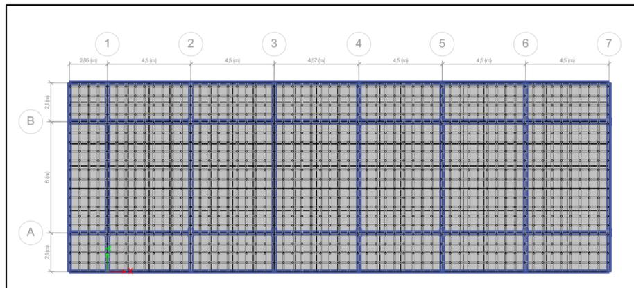
Figura 5: Estructura en vista en planta, piso 1 con pórticos estructurales.
