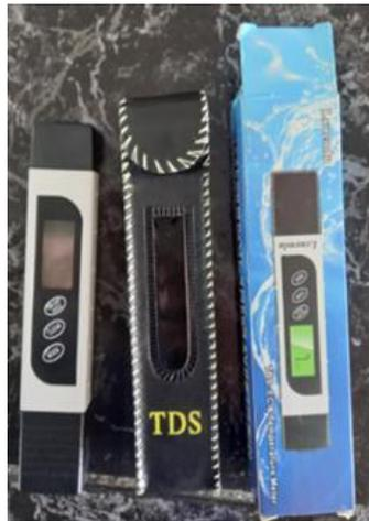
**Figura 8.** Medidor de temperatura, conductímetro y TDS.
