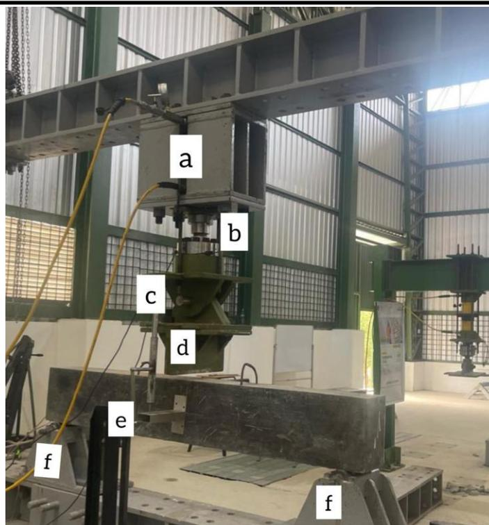
*Figura 3. Instrumentos usados para ensayo a flexión: a) Actuador, b) Acoples, c) Celdas de cargas, d) Acople para ensayo, e) LVDT y f) Apoyos*
