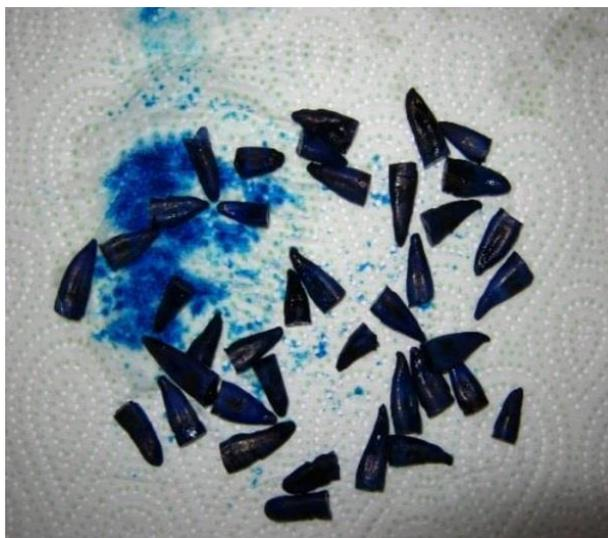
*Figura N° 8.- Piezas sumergidas en azul de metileno secas en papel absorbente*
