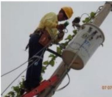
**Figura 4.-** Procedimiento de toma de muestra, prueba con Kit y registro de datos.
