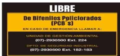
**Figura 7.-** Etiqueta o de Advertencia para los transformadores sin contenido de PCB'S
