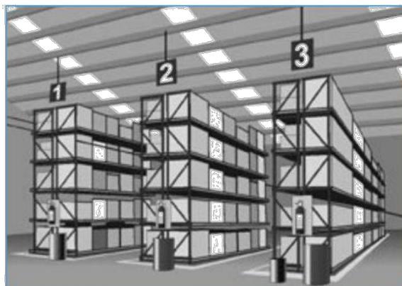
**Figura 15.-** Los pasillos deben ser suficientemente amplios para el tráfico peatonal y vehicular
