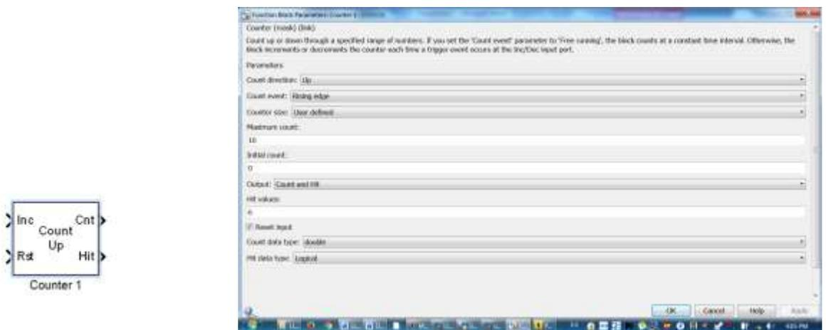
Figura 7. Bloque contador (izquierda) y caja de diálogo con parámetros del bloque.
