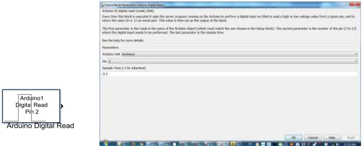
Figura 5. Bloque funcional *Digital Read* (izquierda) y caja de diálogo para configurar el bloque.
